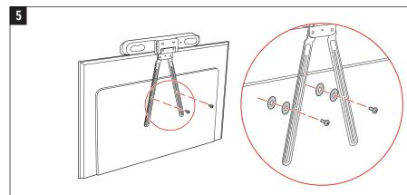
(2) M6 or (2) M8 screws and (0-10) washers appropriate for your display at פור-00). שוני שני וליי או או או בשנים איני שני שני של (10-0). הור (0-10) ושביי שליי בשנים לתצוגה שלך M8 מראר מים לתצוגה שלך M8 (2) ברגים (10 המתאימים לתצוגה שלך M8 מרא מים לתצוגה שלר (10 המתאימים לתצוגה שלר M9 ברגים (10 המתאימים לתצוגה שלר M9 (2) או ברגים (10 (2) sekrup M6 atau (2) M8 dan (0-10) ring yang sesuai untuk layar Anda ja お使いのディスプレイに適した M6 (2 本) または M8 ネジ (2 本) とワッシャー (0~10 個)
