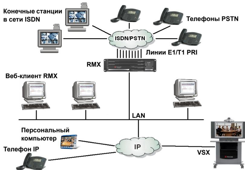
**Рисунок 1-1** Многоточечная видеоконференция, использующая Polysom RMX 2000
