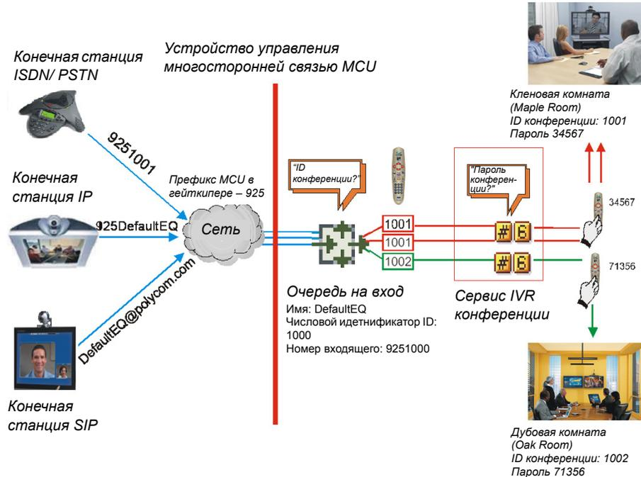
Рисунок 3-1: Входящее подключение через очередь на вход
